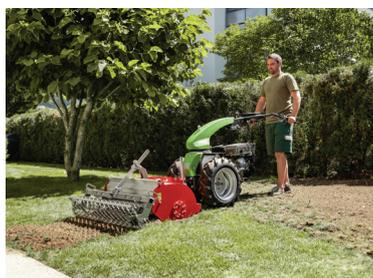
Grâce à son entraînement en continu, à ses accessoires interchangeables sans outils et à son guidon pivotant et inclinable, le Rapid KIPOS est le porte-outils mono-axe multifonctionnel idéal pour l'horticulture et l'aménagement paysager. L'équilibre conçu sans compromis pour les travaux de fraisage du sol permet de travailler facilement et en ménageant ses forces, même pendant de longues journées de travail.
