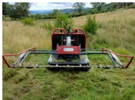
Ijzeren paard met versterkte ontstruiker-maaibalk / Cheval de fer IGX 800 avec barre de coupe renforcé pour broussailles.
