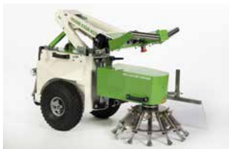
Transportpositie van de stuurboom. Guidon rabattable pour le transport et le stockage.
