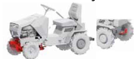
Detail aandrijfunit (links) - Trekhaak (rechts) Entraînement frontal- Attelage arrière
