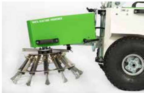
Ook de frontale "neigingshoek" van de borstel is instelbaar. Deze borstel is dus : links-rechts instelbaar in hoek, links-rechts kantelbaar, frontaal kantelbaar. L'angle frontal d'inclinaison de la brosse est également réglable. Cette brosse est donc : réglable en angle gauche-droite, inclinable gauche-droite, inclinable frontalement.
