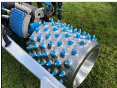
Aluminium egelwals Cylindre à pointes aluminium
