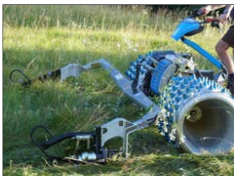
Tussenstukken verlengen het chassis van de maaibalk Des entretoises rallongent le châssis de la barre de coupe
